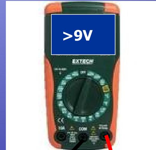
**Sämtliche Verbraucher einschalten. Nach einer Minute darf die Spannung der geladenen Batterie nicht unter 9 V absinken!**
