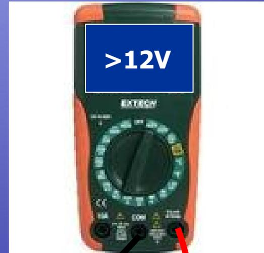
Messung der Ruhespannung der Batterie
