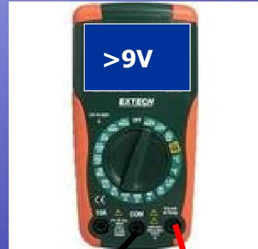
**Während des Startvorgangs darf die Spannung der geladenen Batterie nicht unter 9 V absinken!**
