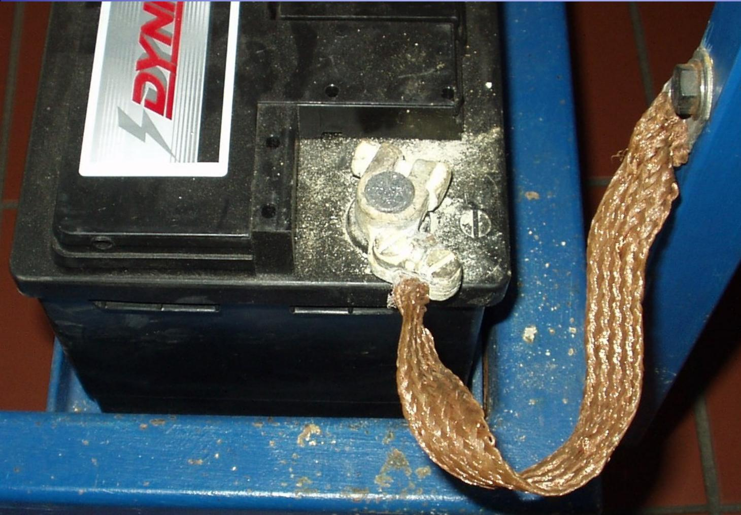
**Kabelanschlüsse dürfen nicht oxidiert sein. Klemmen und Pole können mit Leitungswasser gereinigt werden!**
