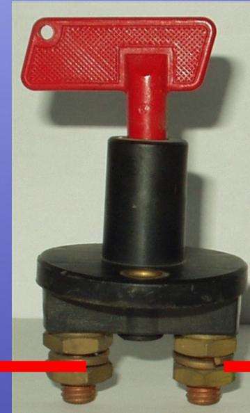
Die Strombelastbarkeit des Batteriehaupschalters muss dem Kälteprüfstrom der Batterie entsprechen. **Im vorliegenden Fall muss die Belastbarkeit mindestens 800 A betragen!**
